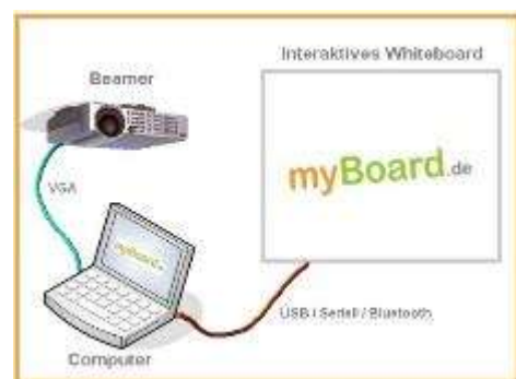
Abb. 2: Aufbau interaktiver Whiteboards
